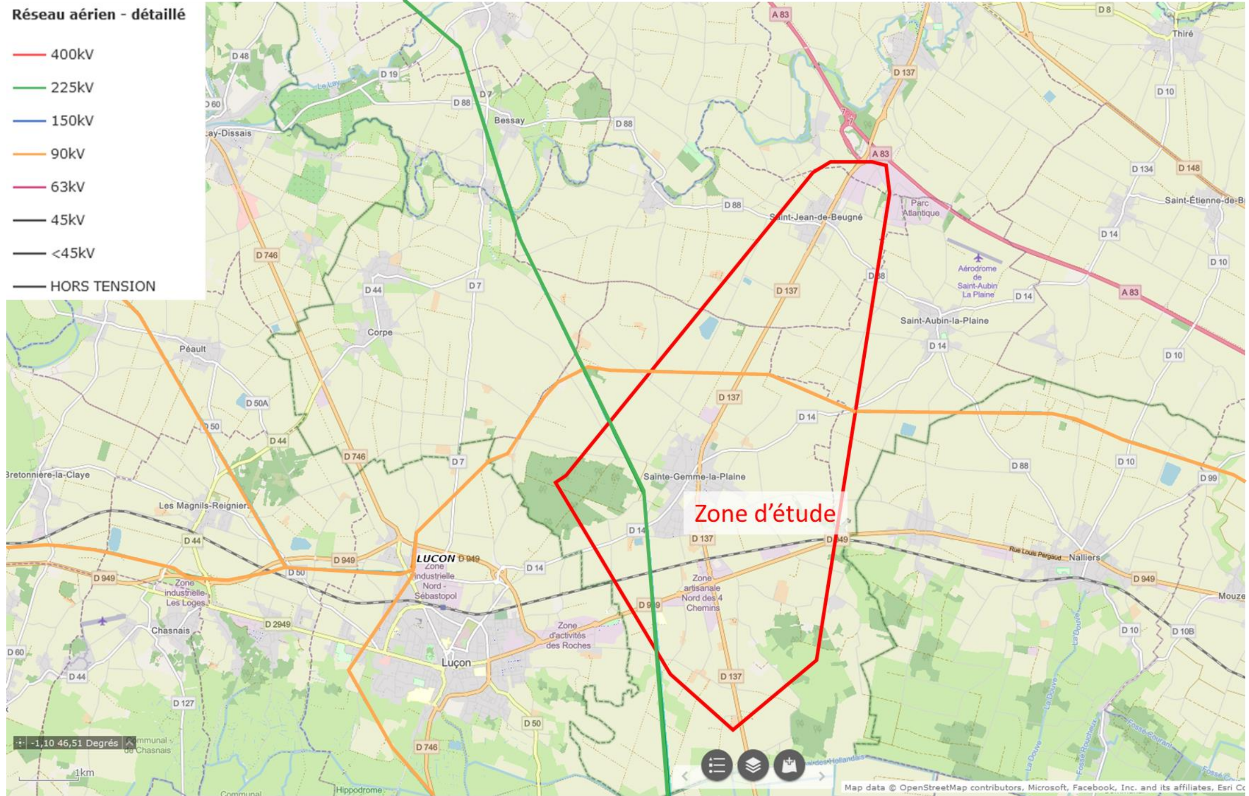
Figure 139 Réseau aérien au droit de la zone d'étude : lignes hautes tension et très haute tension
