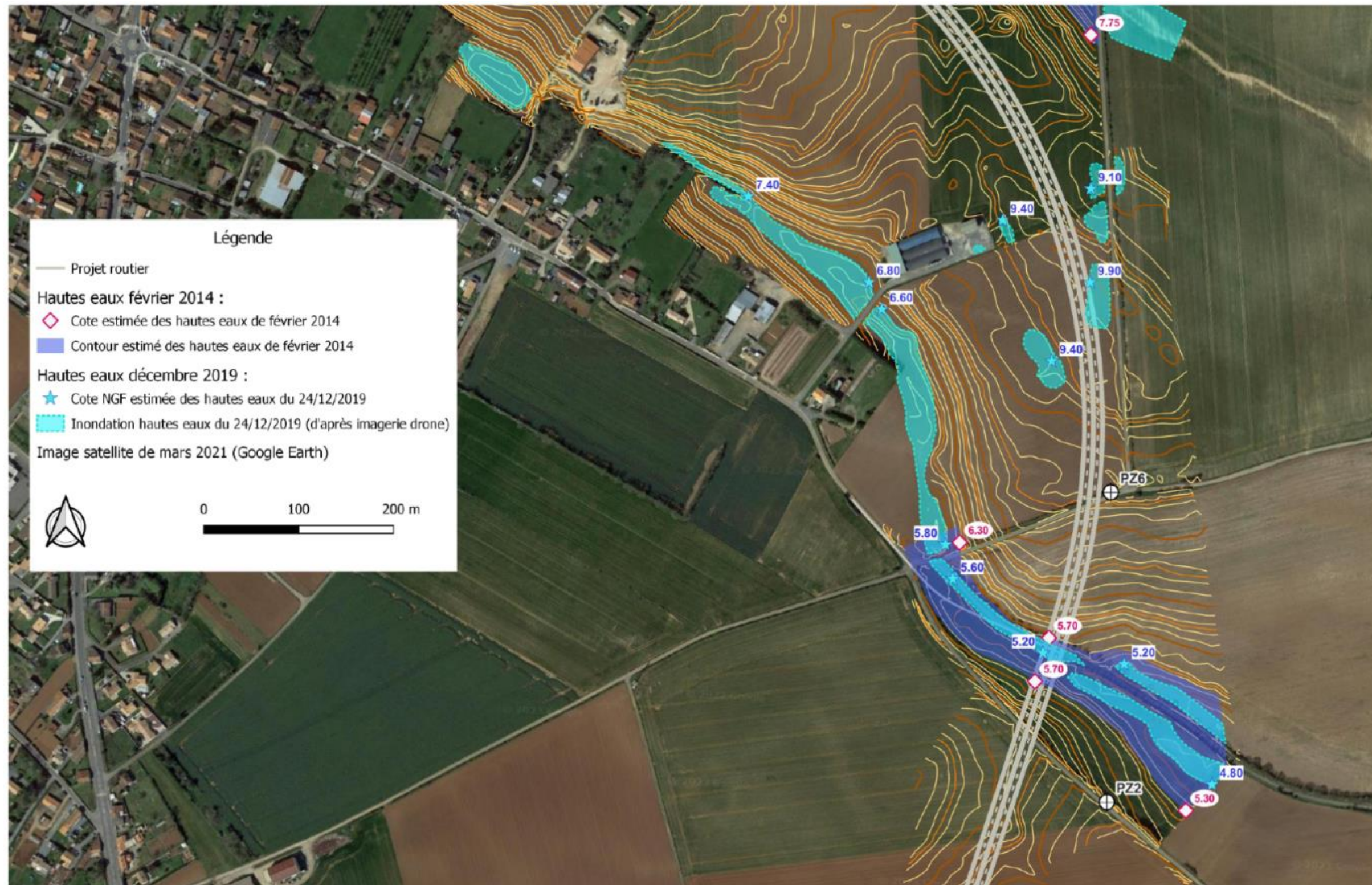
Figure 121 : Estimations des inondations de nappe de décembre 2019 et de février 2014 (secteur est)
